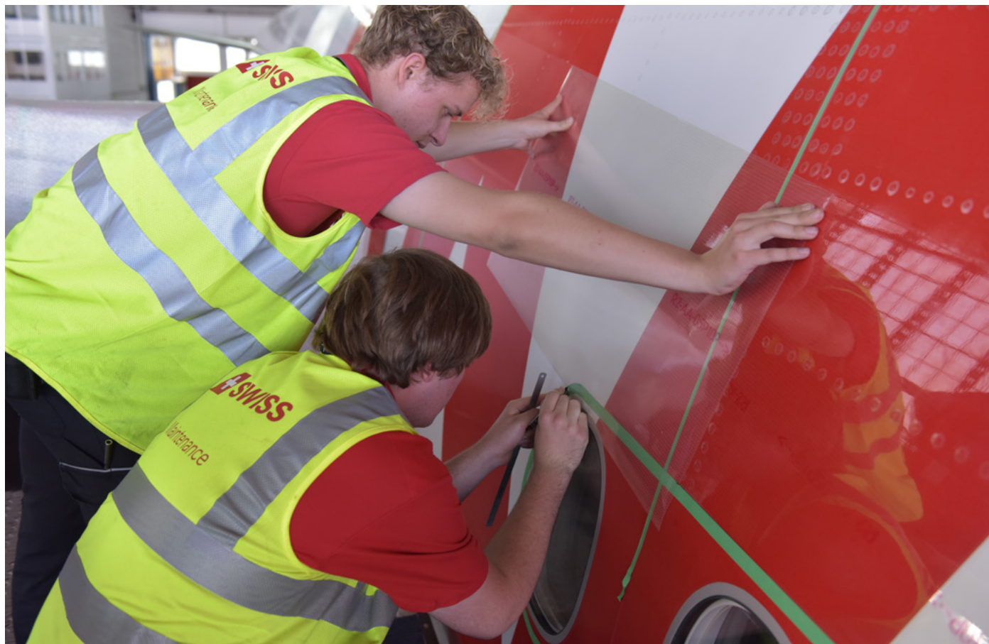
Beklebung des Flugzeugs mit der AeroSHARK-Technologie
